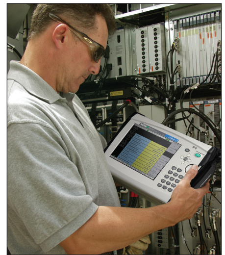
Рис. 4. Специалист изучает спектр на базовой передающей станции
